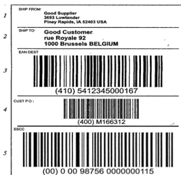
Рисунок 4.14 – Формирование данных о грузе и основная этикетка, с уникальным идентификатором EAN/UCC: 1-данные об отправителе; 2-данные о получателе; 3-ссылка к базе данных перевозчика; 4-ссылка к базе данных получателя; 5-уникальный идентификатор транспортируемой единицы префикс организации.
