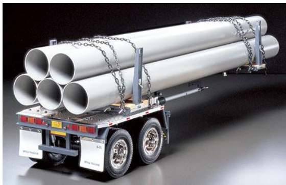
Рисунок 5. 20. Пример укладки и крепления труб.
