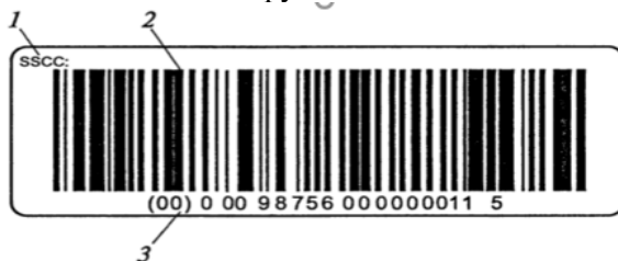
Рисунок 4.11. Основная этикетка EAN/UCC 128: 1 – заголовок штрих-кода; 2 – уникальный идентификатор транспортируемой единицы; 3 – визуальное представление штрих-кода
