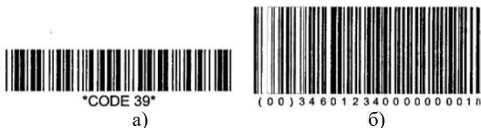
Рисунок 4.6 – Характеристики наиболее распространенных линейных штрих-кодов: а) вид штрихового кода Code 39; б) вид штрихового кода Code 128.
